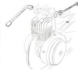
FIG. 7. Vastdraaien bovenste bevestigingsbout (motor hangend halfweg scharnierend).
